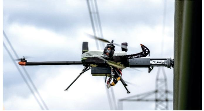
Anhand physischen Kontakts zwischen einer Konstruktion und der Drohne wird eine akkurate Messung der Farb- und Wanddicke ermöglicht. Mit der eigens dafür angefertigten Drohne kann so beispielsweise der Korrosionsschutzanstrich kontrolliert werden. Diese Messungen können nicht nur an Oberflächen von Hochspannungsmasten durchgeführt werden, sondern an einer Vielzahl von Konstruktionen wie Brücken, Tanks, Silos und weiteren Bauwerken.
